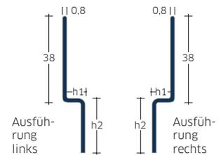
Der BLANKE AQUA-KEIL WAND, Gefällekannte aus Edelstahl, für die perfekte Detaillösung an Gefälleflächen zum Anschluss an Wände bei Linienentwässerungen. Als rechte und linke Ausführung erhältlich.
